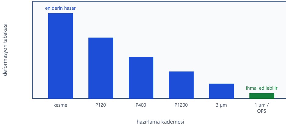
Şekil 2 — Her kademe, bir öncekinin bıraktığı deformasyon tabakasını kaldırır. Bir kademe atlanırsa hasar yüzeyin altında kalır ve dağlamadan sonra yanıltıcı bir yapı olarak görünür. (SAE Mühendislik özgün çizimi, şematiktir.)
